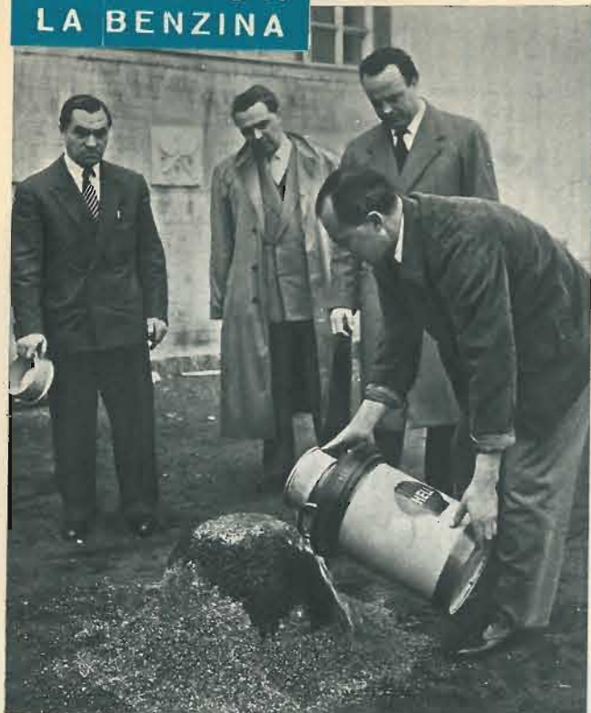
L'esperimento della « campana di Secondite » consiste in questo: si forma, attorno a del materiale sensibilissimo al calore, un involucro di Secondite. Il materiale può essere, per esempio, burro. Sull'involucro si versa della benzina.
