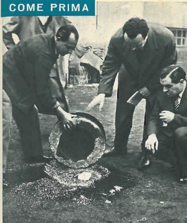
Quando le fiamme sono spente l'involucro di Secondite viene spezzato e si può constatare che il materiale sensibile al calore è rimasto intatto, mentre la temperatura è rimasta, nell'interno, assolutamente eguale a quella preesistente.
